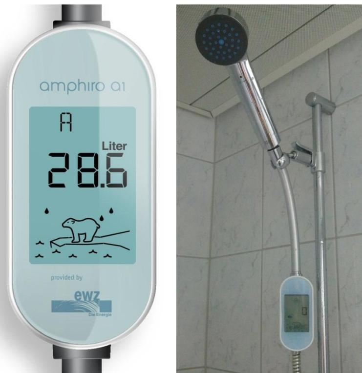
Abbildung 3: Verbrauchsanzeige während des Betriebs (links) und eingebaut in eine Dusche (rechts).
